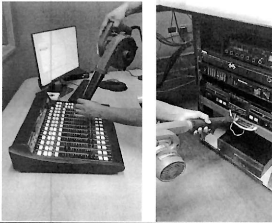
Limpieza y aspiración de consola y de equipo de audio en las cabinas de transmisión y de producción.
