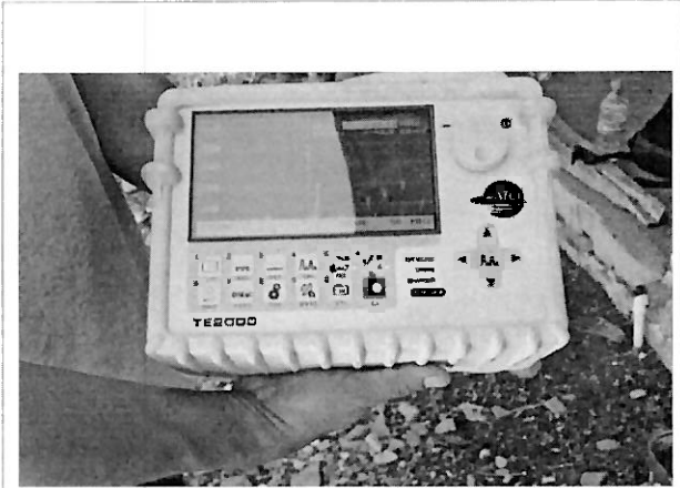
Se verifica con el analizador la señal que se recibe, el nivel de la portadora está muy bajo.
