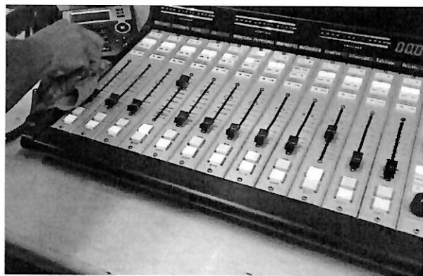
Limpieza de consola de transmisión y aspirado de equipos periféricos
