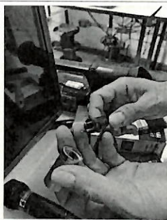
Cambio de conector XLR en el cable del receptor del sistema de microfonía inalámbrica
