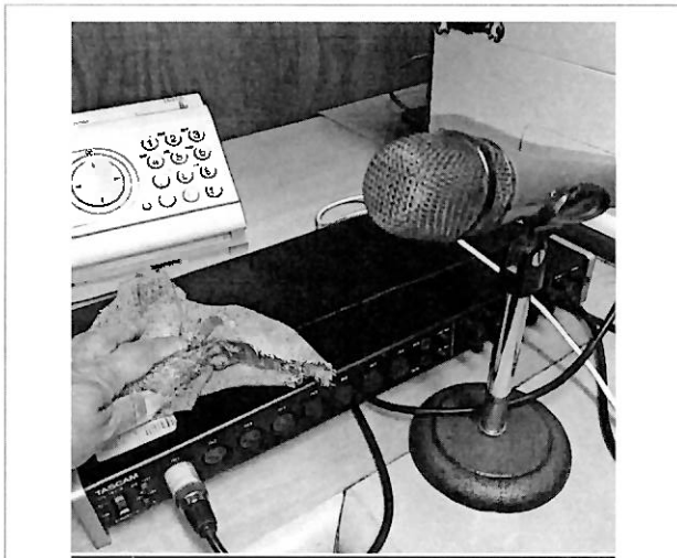
Limpeza de consola, interface y diversos equipos de audio en las cabinas de transmisión y de producción.
