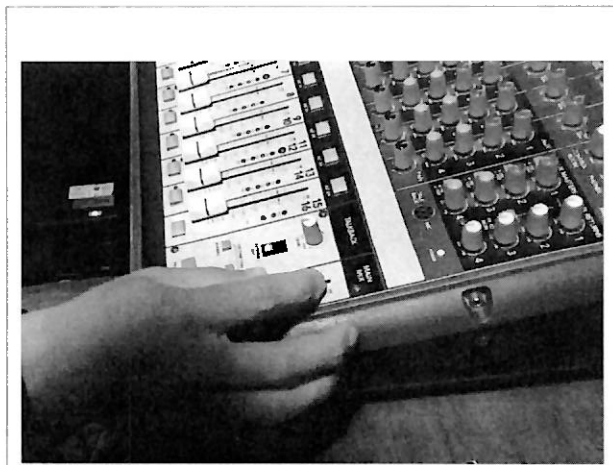
Limpieza de consola de producción, de controles deslizables con aire comprimido y líquido lubricante
