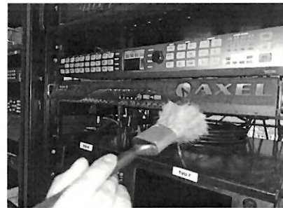
Limpeza en seco a la electrónica del "play Out"
