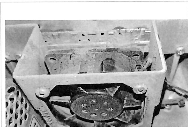
Ventilador con exceso de polvo que entra en el equipo por estar cerca de la puerta, provoca que tuviera baja velocidad y vibración.
