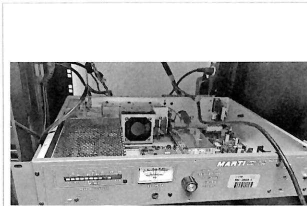
Ventilador con exceso de polvo que entra en el equipo por estar cerca de la puerta, provoca que tuviera baja velocidad y vibración.
