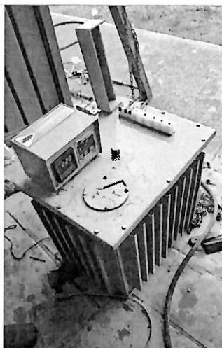
Se arma el equipo y se le aplica voltaje, se prueba el voltaje de salida, y se ajusta para el trabajo en campo.
